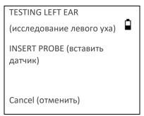
Вставьте ушной вкладыш в ухо и достигнете изоляции уха. При определении надлежащей изоляции отобразится следующая последовательность сообщений:
