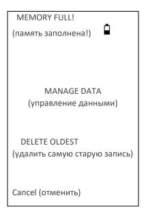
При выборе MANAGE DATA (управление данными) на экране отобразится меню DATA MANAGEMENT (управление данными), в котором можно распечатать или перенести данные на компьютер перед удалением записей, чтобы освободить место для нового теста.
