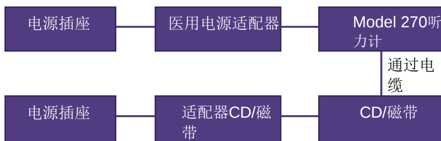
图5: Model 270听力计与医学认可的电源适配器和外部扬声器一起使用
