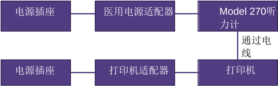
图2: Model 270与医学认可的电源适配器和打印机一起使用
