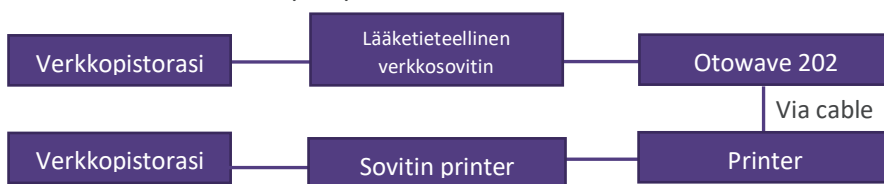
Kaavio 3: Otowave 202 käytössä lääketieteellisesti hyväksytyn verkkosovittimen ja tietokoneen kanssa
