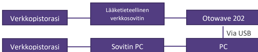
Kaavio 3: Otowave 202 käytössä lääketieteellisesti hyväksytyn verkkosovittimen ja tietokoneen kanssa
