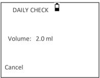
Rimuovere la sonda e ripetere il test con le tre cavità rimanenti. Il display dovrebbe mostrare il volume delle cavità di test da 0,2ml e 0,5ml entro ± 0,1ml. La cavità di test da 5,0 ml deve essere entro ± 0,25 ml.
