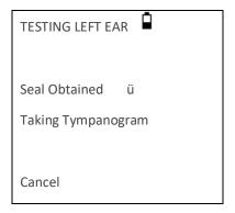
Una volta che viene rilevata una tenuta adeguata, viene effettuata il timpanogramma. Ciò richiede circa 3 secondi. È importante non spostare la sonda e chiedere al paziente di rimanere molto fermo durante il test..
