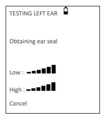
Il numero di barre indicate indica la robustezza della tenuta. La sonda deve essere regolata nell'orecchio fino a quando due o più barre sono indicate per Low & High.
