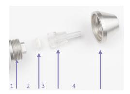
Capo e Ghiera Connessione sul corpo sonda per il posizionamento del puntale 1 2 Guarnizione in gomma Guarnizione utilizzata per garantire il flusso d'aria 3 Punta della sonda Punta della sonda trasparente che alloggia la guarnizione in gomma 4 **Puntale** Parte superiore della sonda per fissare saldamente la punta della sonda e sigillare la gomma
