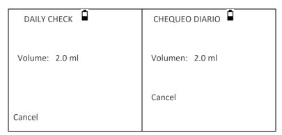
Quitar la sonda y repetir la prueba con las tres cavidades de ensayo restantes. La pantalla debe mostrar el volumen de las cavidades de 0,2 ml y 0,5 ml de prueba de ± 0,1 ml. La cavidad de ensayo 5,0 ml debe estar dentro de ± 0,25 ml.
