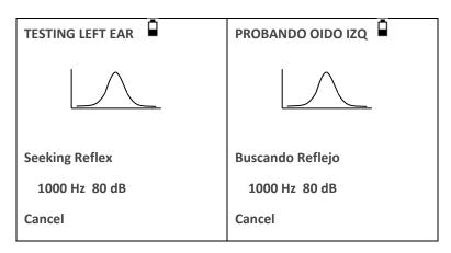
La pantalla cambia para mostrar la frecuencia y el nivel usado, empezando con la frecuencia más bajar y el nivel seleccionado.
