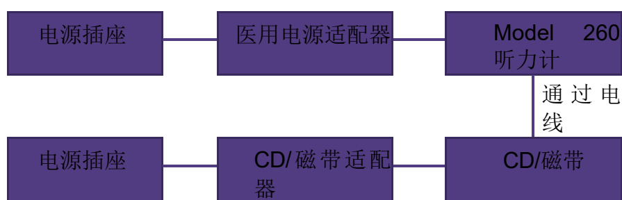
图5: Model 260 听力计与医学认可的电源适配器和外置扬声器一起使用
